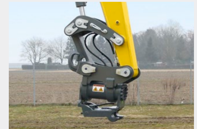
Powertilt met hydraulisch snelwisselsysteem Easy Lock.
